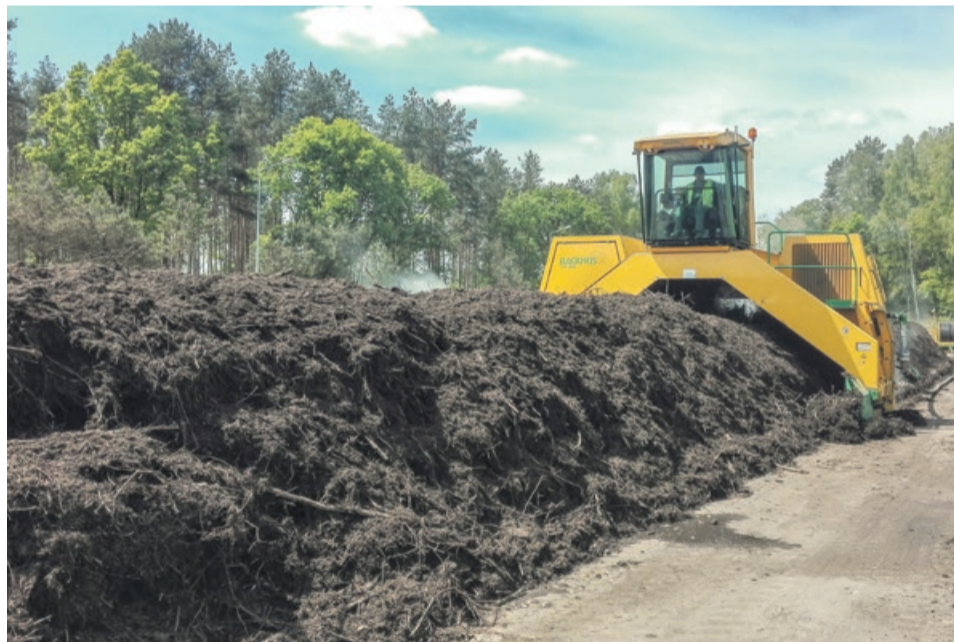
Przerzucanie, nawadnianie i napowietrzanie kompostu fot. ZZO Marszów
